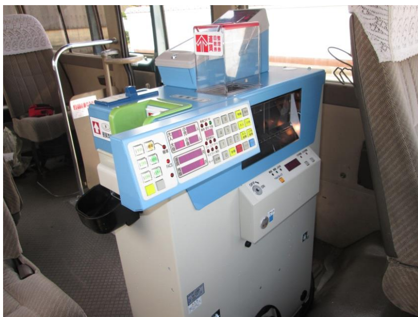
I r u C a システム（運賃箱・操作盤・降車 R/W）
